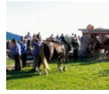
23 Ross am Göppel Drehwerk zum Antrieb ortsfester Maschinen durch Zugtiere oder Menschen
